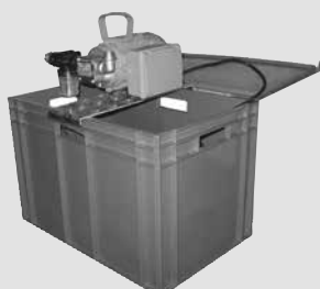
SOLARBEFÜLL- UND SPÜLPUMPE UNISTAR 2000A trocken selbstansaugende Impellerpumpe mit EingangsfILTER aus Klarglas zum Befüllen von Solaranlagen mit Wärmeträgerflüssigkeit, Ansaug-, Füll- und Spülschlauch mit 3/4" Überwurf, Kunststoffbehälter mit Deckel, max. 30l/min, max. 5 bar, 230V, 50Hz, 3,2A
